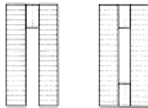
section en U retourné, section à caisson
