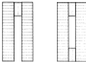
section en U retourné, section à caisson
