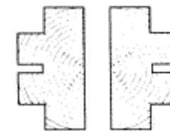
sections en croix à partir de profils à cœur refendu et gorge de décharge
